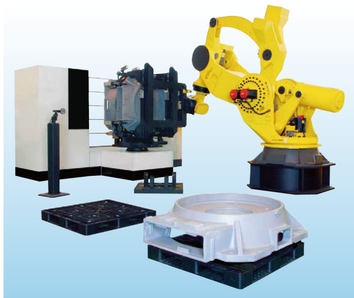
使用M-2000iA/1200把大型铸件装上机械加工用夹具
