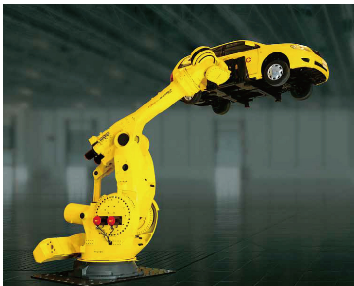
使用M-2000iA/1700L搬运完成车体
